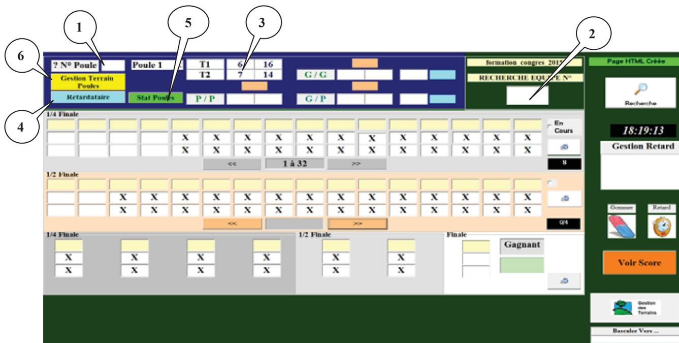
**Zone 1** ⇒ permet d'accéder rapidement à une poule en indiquant le numéro de poule et taper : « entrer »
